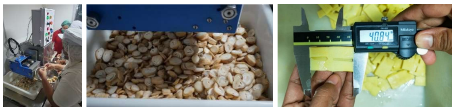
รูปแสดงเทคโนโลยีการหั่นหน่อไม้ด้วยระบบกึ่งอัตโนมัติพร้อมสายพานลำเลียง(ซ้าย) รูปแสดงเห็ดฟางและหน่อไม้ที่ผ่านกระบวนการหั่นด้วยระบบกึ่งอัตโนมัติ (กลาง,ขวา)
