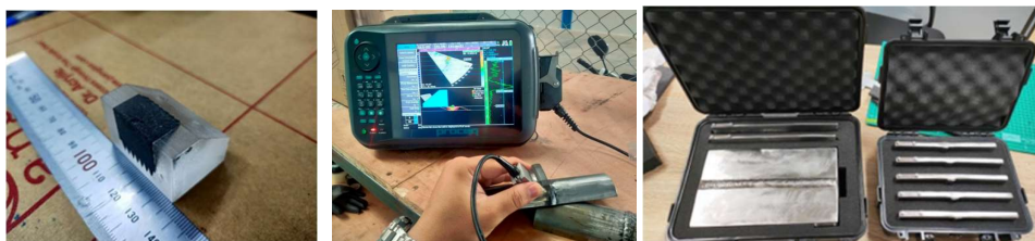
รูปแสดงการทดสอบรอยความไม่ต่อเนื่อง โดยใช้ไฟลการสอบเทียบสัญญาณอ้างอิงจากชิ้นงานที่สร้างขึ้น (ซ้าย และ กลาง)
